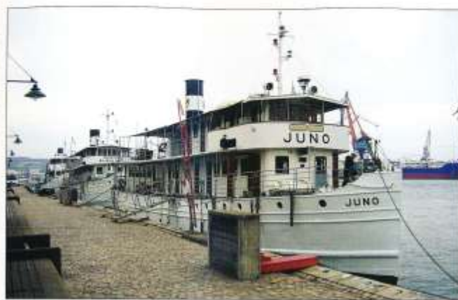
I vintern har Göta Kanalrederiets JUNO, byggd 1874, genomgått en större upprustning på Ö-Varvet. Nytt dieselmotoreri är det väsentliga, den nya skorstenen av ångbåtsmodell är kanske det som syns mest. Foto Gunnar Söderberg 27 april 2009
