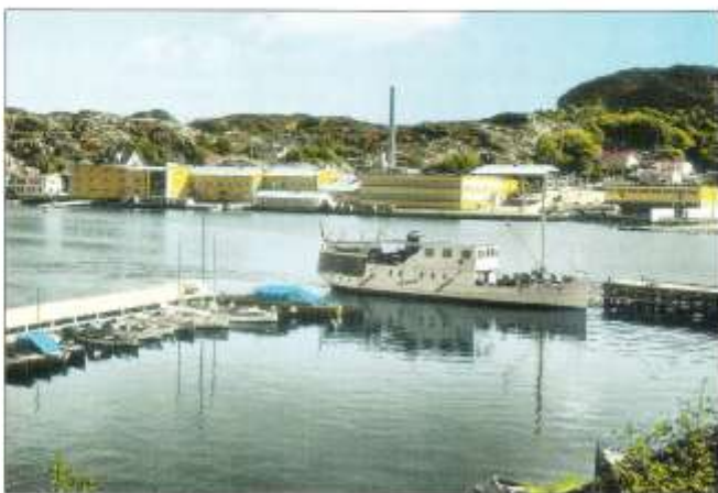
Tjörn på väg in till Ellis brygga på Orust. Tjörn är motoriserad och har fått en ny skorsten. Övre däck har försatts med vindskydd. I bakgrunden konserverfabriken Skandiakonvers, Vjboert
