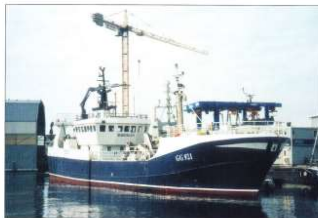
BOHUSLÄN AV FISKEBÄCK vid Ö-varvet på Öckerö. Fartyget är av typen bäcktrålare med största längd 39,20 m och brutto 413. Foto Göran Ohlsson 10 mars 2009
